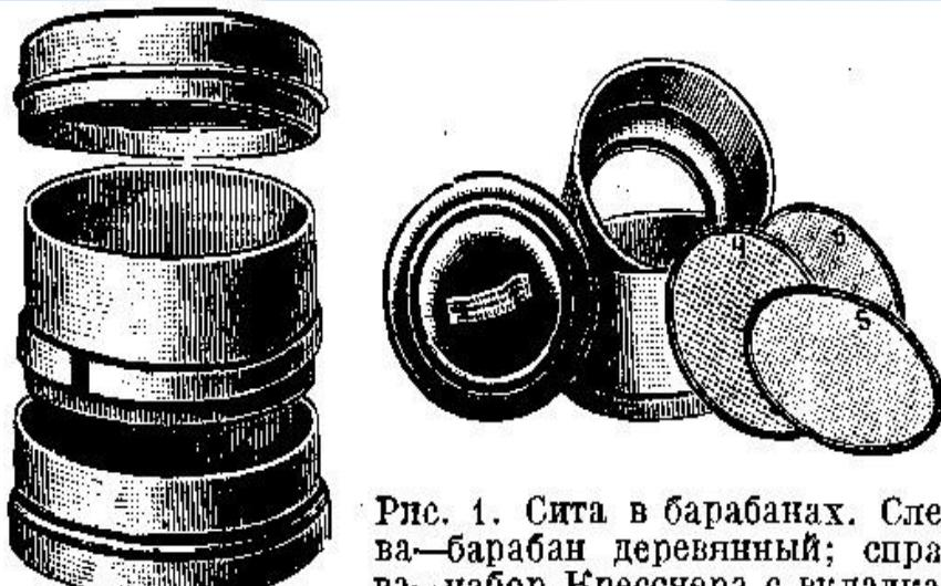
Рис. 1. Сита в барабанах. Слева—барабан деревянный; справа—набор Кресснера с вкладками разных номеров сит.
