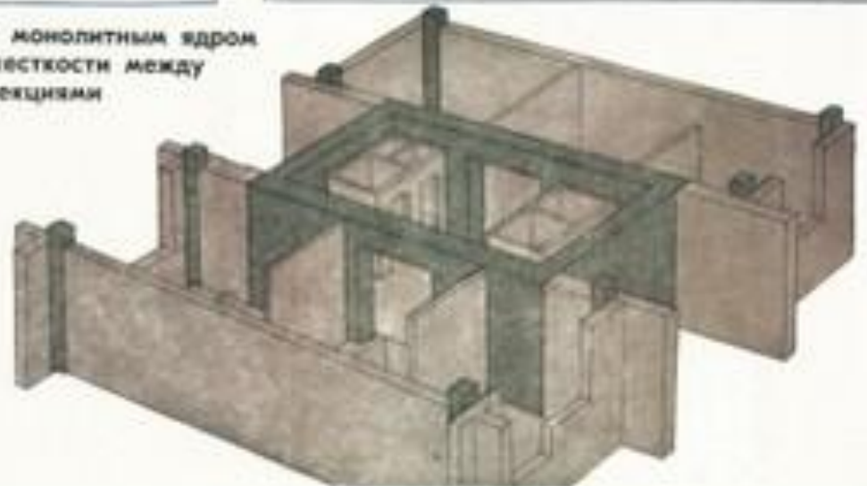
Рис.5 Основные конструктивные системы гражданских зданий: I - стеновая; II - каркасная; III - ствольная; IV - оболочковая; V - объемно-блочная, 1 - несущая наружная ограждающая конструкция, 2 - то же, ненесущая, 3 - внутренняя несущая конструкция, 4 - несущий объемный блок
