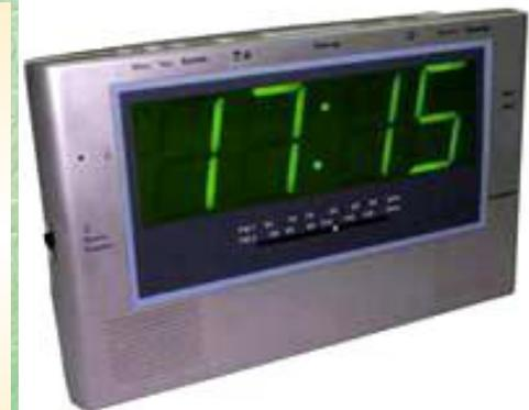
Функциональные особенности: стилизован под настольные электронные часы с сохранением всех функций; подавляемые стандарты — GSM, CDMA, DAMPS, AMPS, NMT; радиус подавления — до 15 метров (зависит от удаленности от базовой станции).
