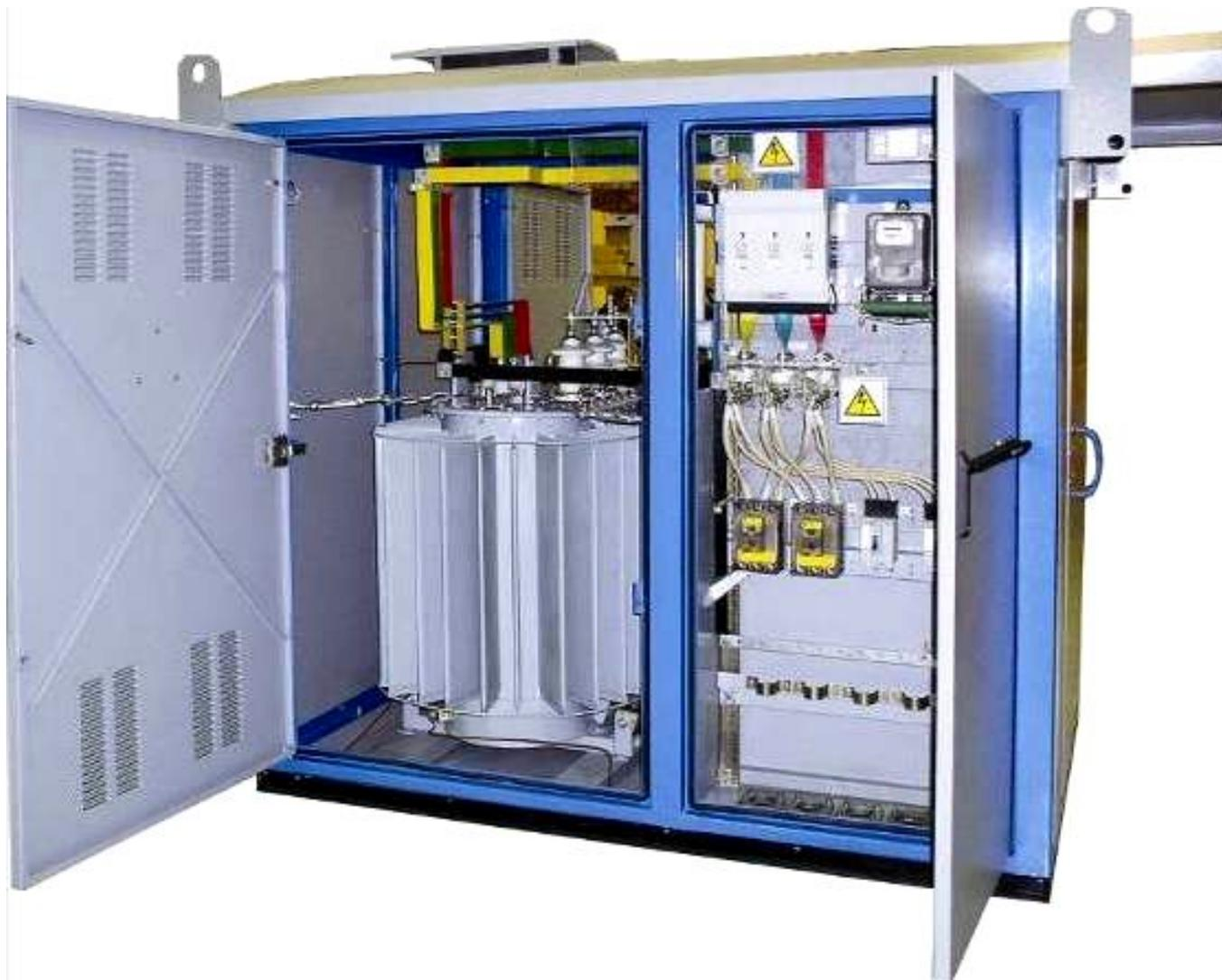
Подстанции трансформаторные комплектные тупиковые мощностью 100, 160, 250кВ·А, напряжением ВН 6 или 10 кВ напряжением НН 0,4кВ
