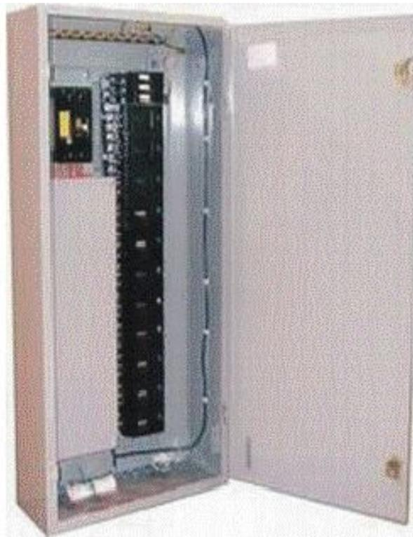
Пункты распределительные ПР11 предназначены для распределения электроэнергии, защиты электрических установок напряжением до 660 В переменного тока частотой 50 и 60 Гц при перегрузках и коротких замыканиях, а также для нечастых (до 3-х включений в час) оперативных коммутаций электрических цепей и прямых пусков асинхронных двигателей.
