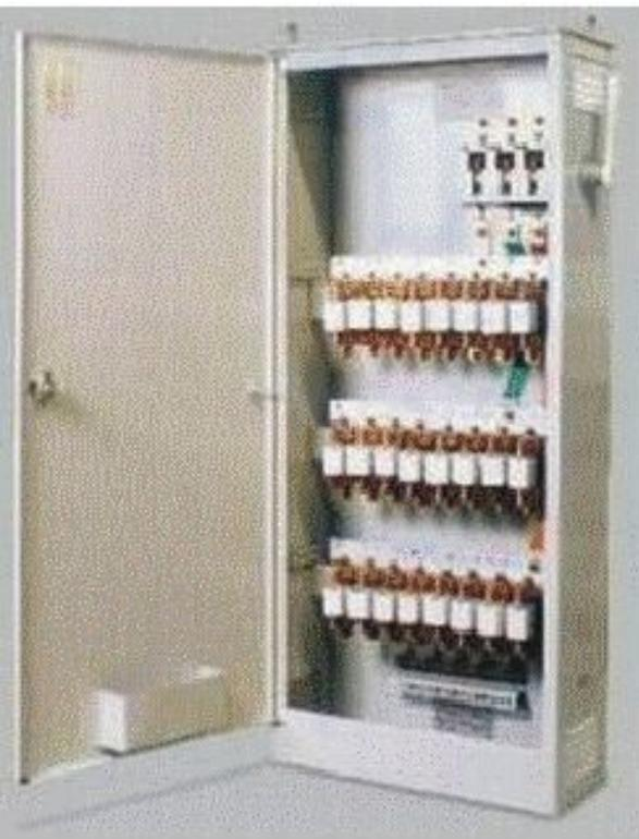
Щафы распределительные силовые ЩРС-1 и ЩР-11 предназначены для приема и распределения электрической энергии. Щафы рассчитаны на номинальные токи до 400 А и номинальное напряжение до 380 В. Ввод и вывод проводов и кабелей предусмотрены снизу и сверху шкафа.
