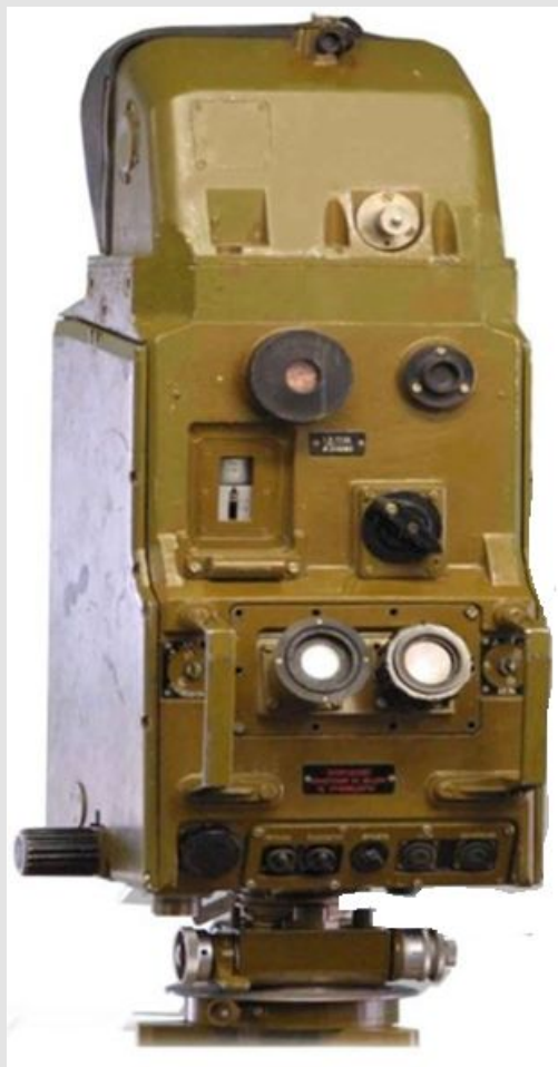
Приемопередатчик дальномера ДАК-1:
