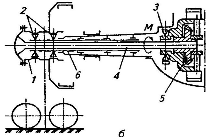
**Главная передача** предназначена для увеличения вращающего момента и передачи его к ведущим колесам. Основными классификационными признаками главных передач являются передаточное число, тип и взаимное расположение применяемых в них зубчатых передач.
