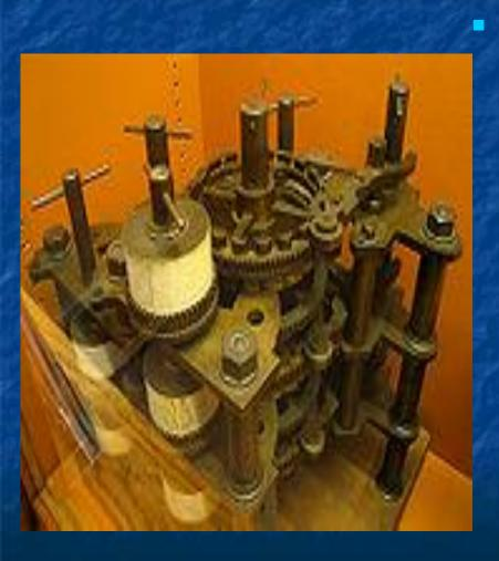
В 1835 году Чарльз Бэббидж описал свою аналитическую машину. Это был проект компьютера общего назначения, с применением перфокарт в качестве носителя входных данных и программы, а также парового двигателя в качестве источника энергии. Одной из ключевых идей было использование шестерней для выполнения математических функций.
