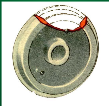
Излом по трещине у отверстия для водила
