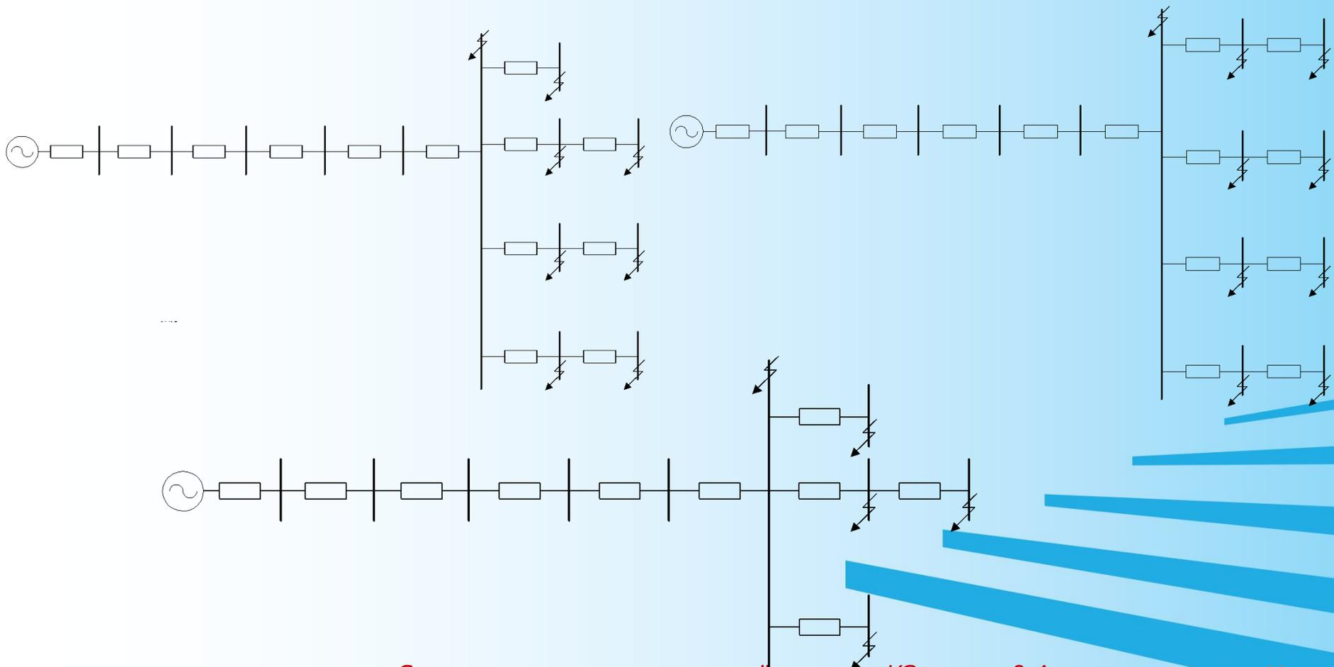
Схемы замещения для расчёта токов КЗ в сети 0,4 кВ
