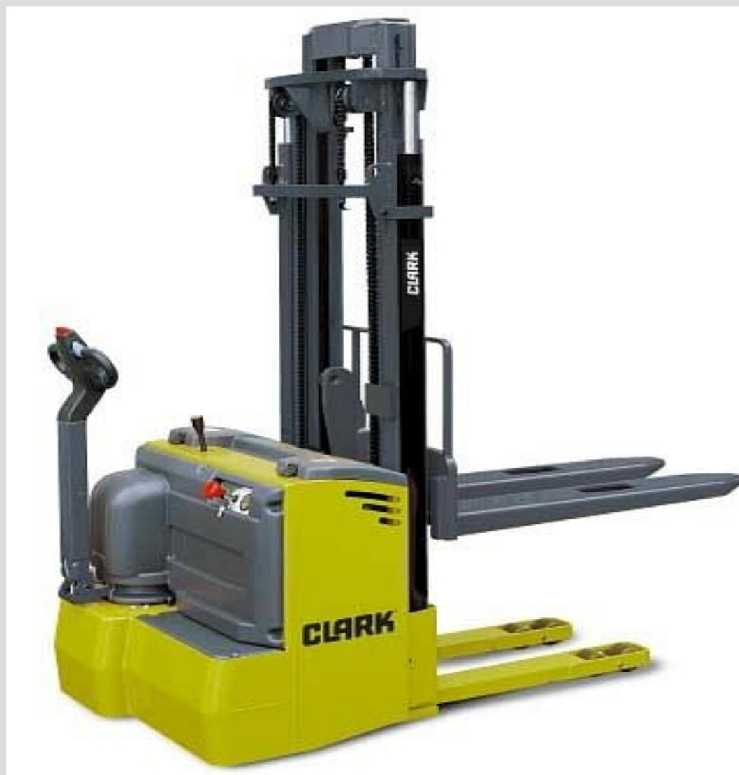
***Штабелёр (англ. Stack-er) — это транспортное средство, оборудованное механизмом для подъёма, штабелирования (хранения и перевозки грузов с установкой их друг на друга) или перемещения грузов, приспособленных для перевозки различными видами транспорта.***
