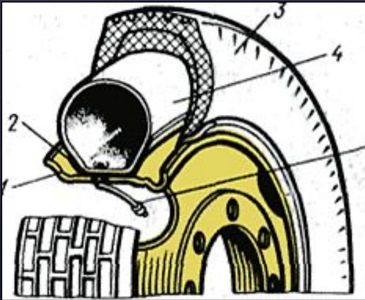
*Автомобильная шина в сборе с колесом*
