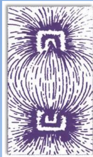
Поле полосового магнита
