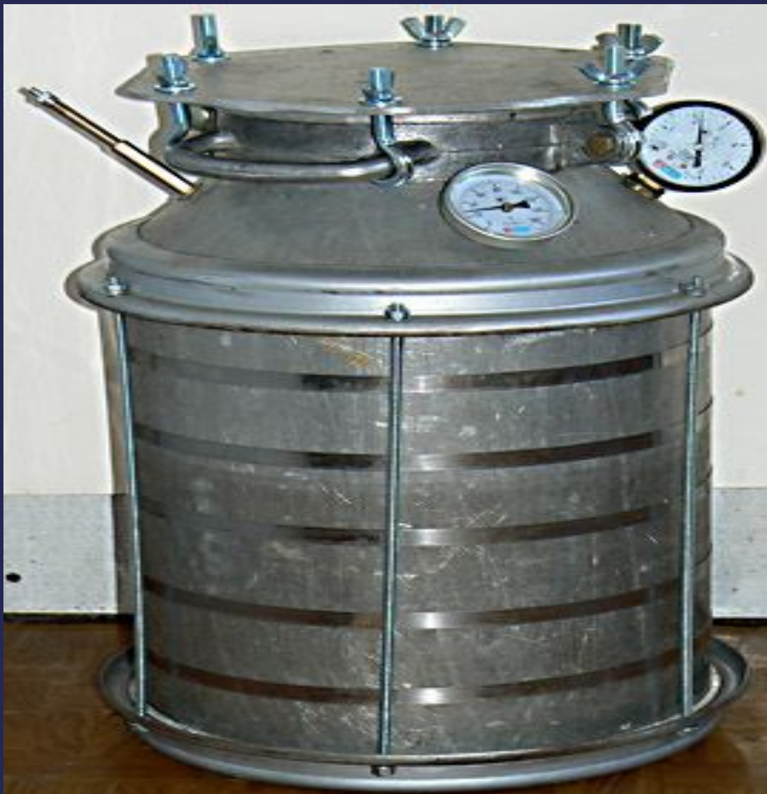
3.1 сурет – Үй жағдайында Стерилизациялауға арналған автоклав.
