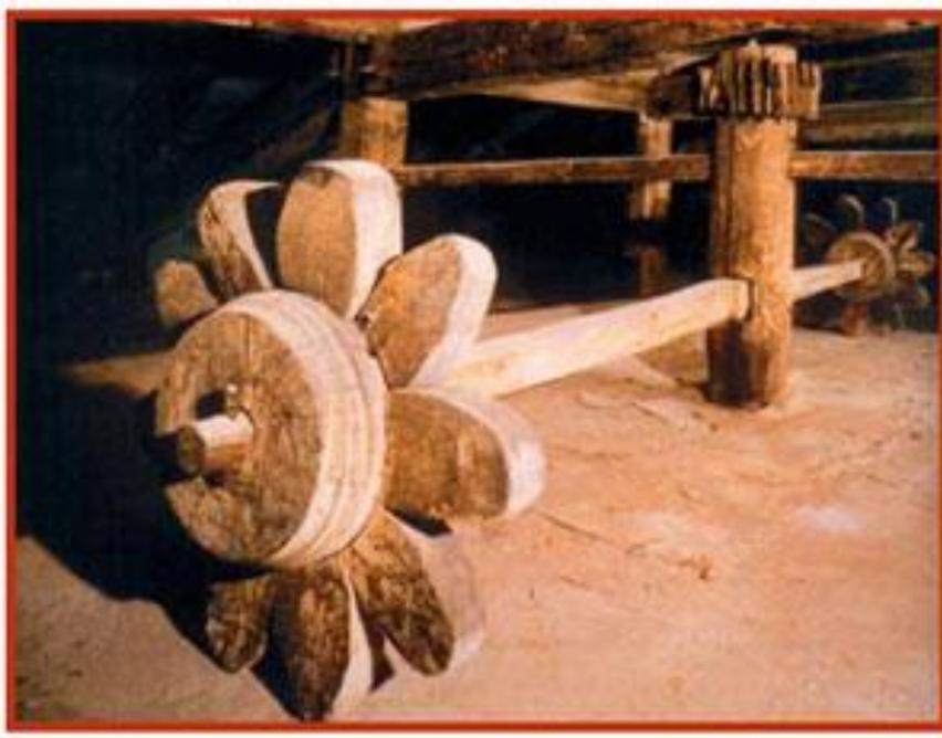
Над авансценой находилась машина грома (8), сконструированная из пустого ящика-резонатора и двух зубчатых колес, которые при вращении ударяли по ящику и создавали звук, напоминающий удары грома. Рабочий сцены, упираясь руками в горизонтальный вал, приводил в круговое движение колесную пару. Машина грома была необходима в театре не только для создания эффекта грозы, но и в связи с тем, что в спектаклях достаточно часто участвовал бог-громовержец.
