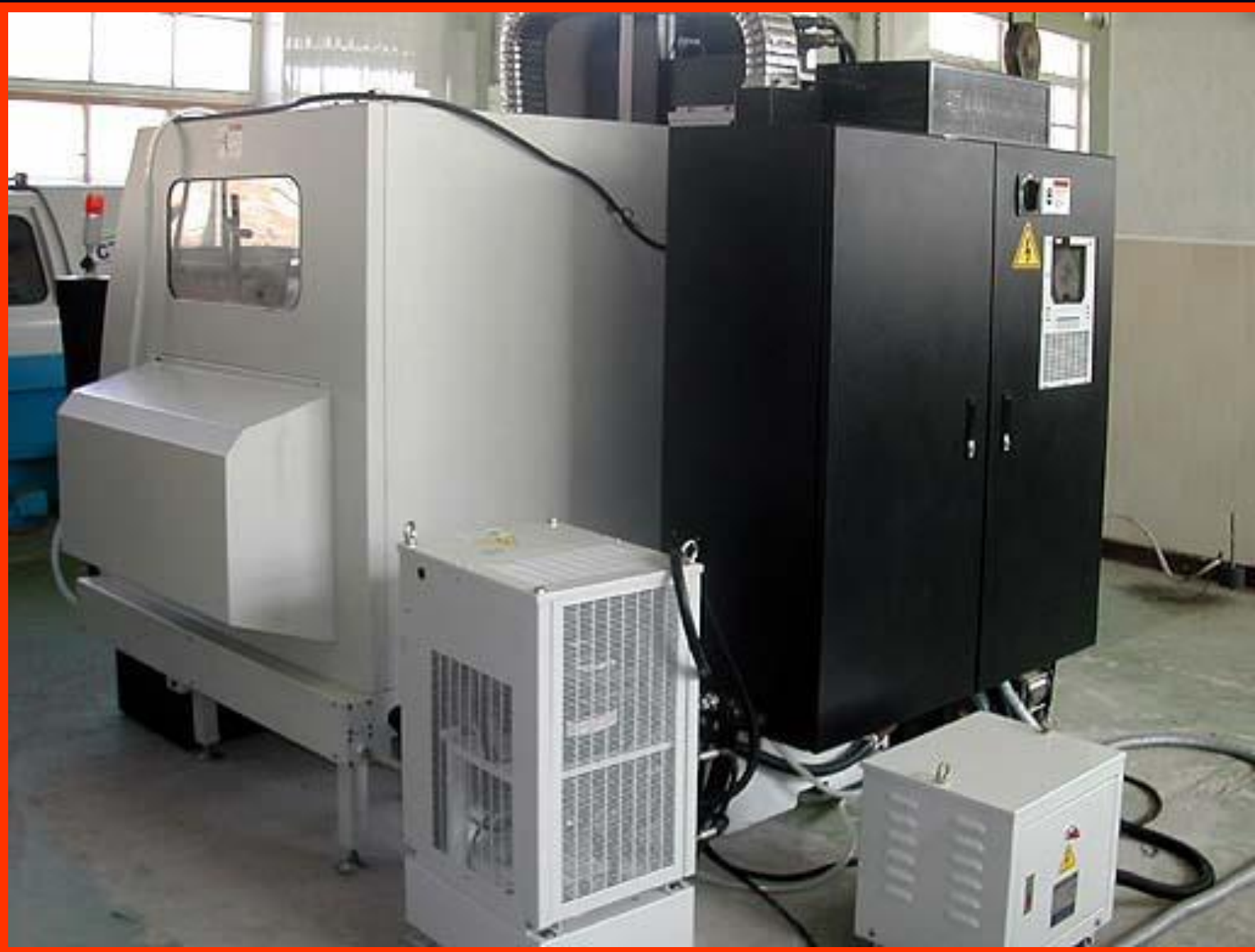
компрессорная система охлаждения шпинделя токарного станка с ЧПУ (вид сзади)
