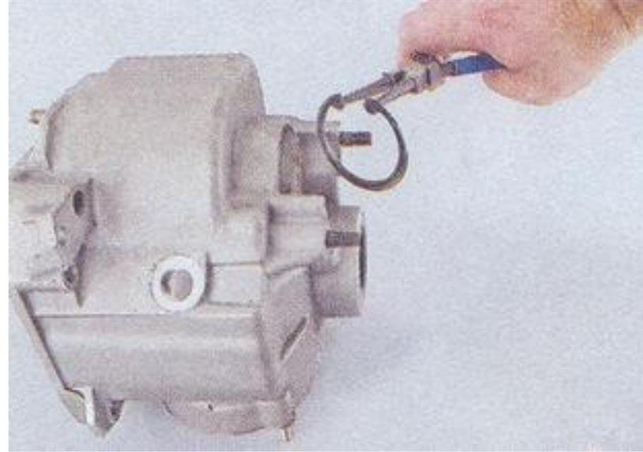
Щипцами вынимаем из проточки в крышке упорное кольцо подшипника блока шестерен
