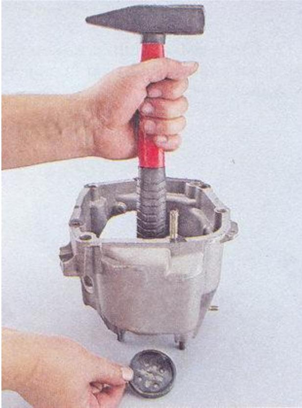
Извлекаем из задней крышки пластмассовую заглушку
