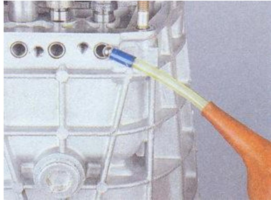
Далее аккуратно вынимаем пружины фиксаторов штоков, затем вынимаем шарики-фиксаторы, и заменяем их
