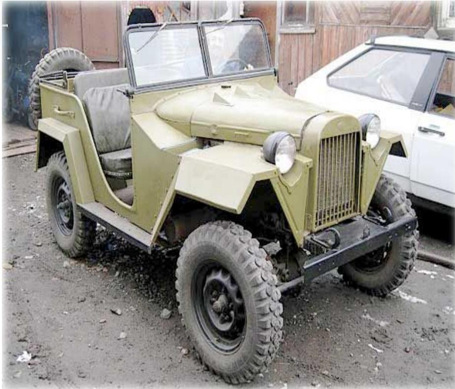
ГАЗ-64 — советский военный полноприводный автомобиль с упрощённым открытым кузовом, имевшим вырезы вместо дверей. Считается первым советским серийным внедорожником. ГАЗ-64 предназначался для использования в качестве командирского автомобиля и лёгкого артиллерийского тягача, но в армии фактически использовался и как транспортное средство пехоты, способное при кратковременной перегрузке перевезти до отделения бойцов.
