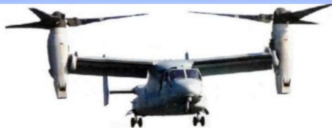
СВВП Bell-Boeing V-22 «Osprey» с поворотными ТВД на концах крыла
