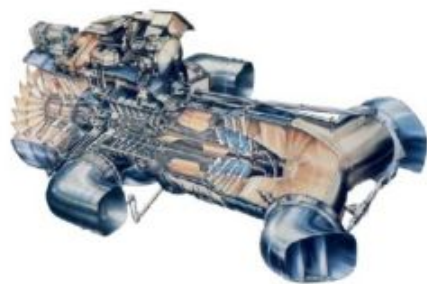
Подъемно-маршевый двигатель «Pegasus» с поворотными соплами
