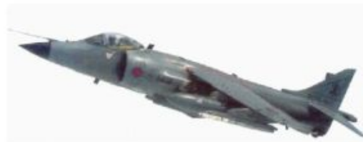
СВВП «Harrier» с подъемно-маршевым двигателем «Pegasus»
