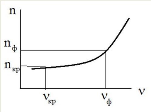
1). Нормальная дисперсия наблюдается для света видимого диапазона в стекле. Рассмотрим распространение белого света в стеклянной пластинке (рис.2):
