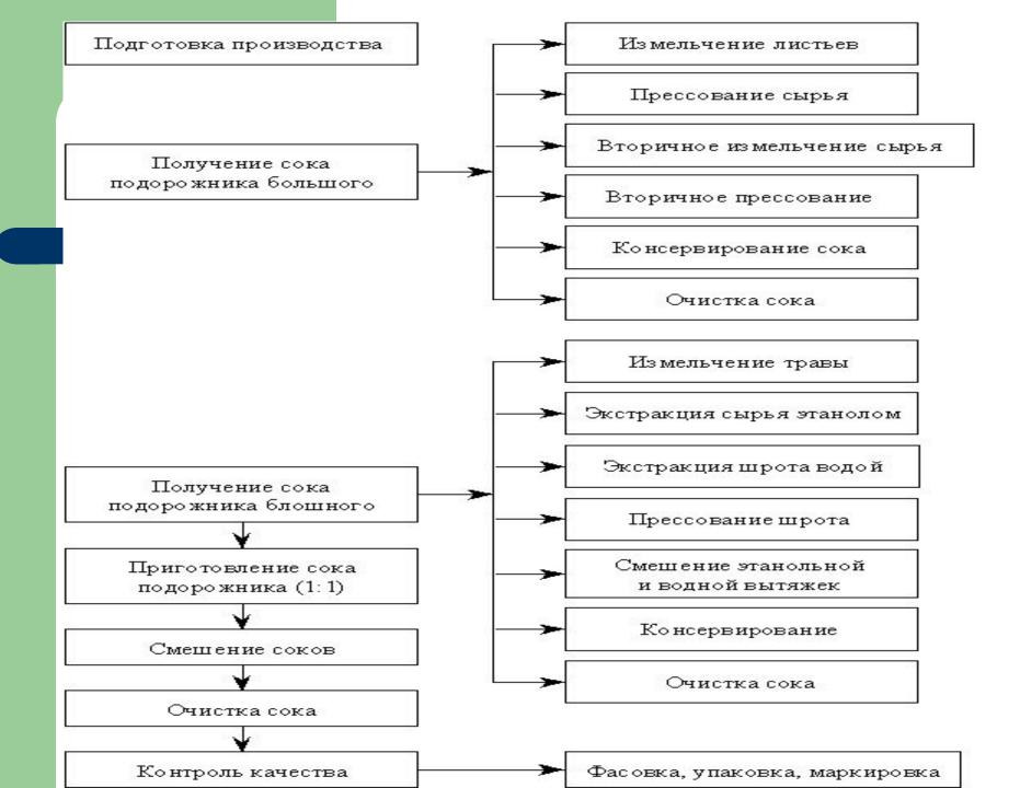
• При вторичном прессовании выход сока около 10%. К отжатому соку немедленно при перемешивании добавляют 25 % этанола, что обеспечивает необходимое содержание его в конечной смеси в количестве 20 %, отстаивают в течение 3 суток и фильтруют через вакуумный фильтр «Грибок», добавляют натрия метабисульфит 0,15%.
