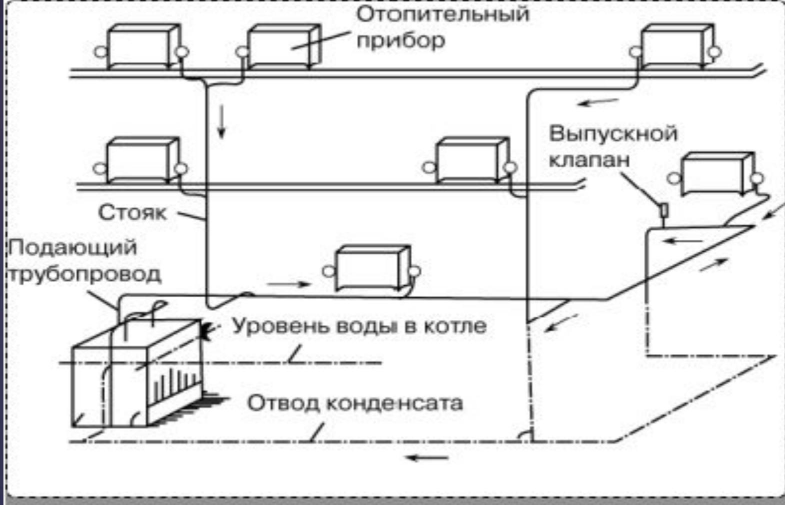
**Рис. 3. СОСТАВНЫЕ ЭЛЕМЕНТЫ СИСТЕМЫ ПАРОВОГО ОТОПЛЕНИЯ**
