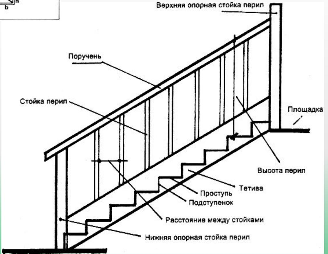
Рис.4. Схематическое изображение лестницы
