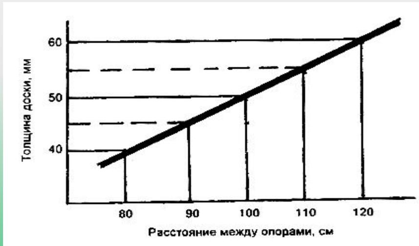
Рис.10. График зависимости толщины доски ступеней от расстояния между опорами.
