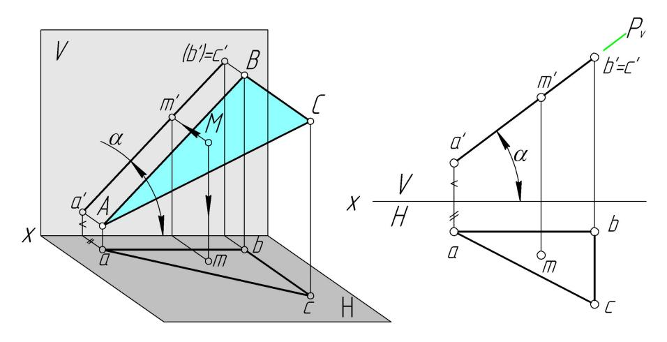
$P(\Delta ABC); \ P \perp V \rightarrow \ a'b'c' \subseteq P_{V'};$   $\alpha$  - угол наклона к плоскости H
