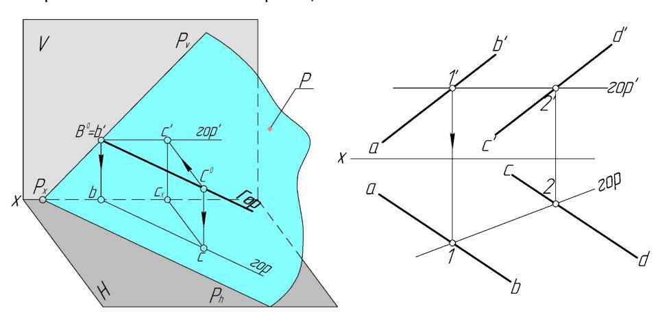
Горизонталями плоскости называют прямые, принадлежащие плоскости и параллельные горизонтальной плоскости проекций.
