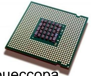
**Тактовая частота процессора** характеризует быстродействие компьютера. Режим работы процессора задается микросхемой, которая называется генератором тактовой частоты. Это своеобразный метроном внутри компьютера. На выполнение процессором каждой операции отводится определенное количество тактов.
