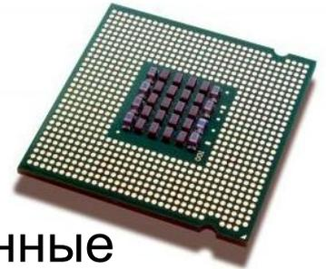
Основа вычислительной машины - **процессор**. Данные процессор считывает из ОЗУ (оперативной памяти) компьютера, туда же он пересылает результат действия над этими данными. Важнейшими характеристиками процессора являются: разрядность, тактовая частота, адресное пространство, размер кэш-памяти.
