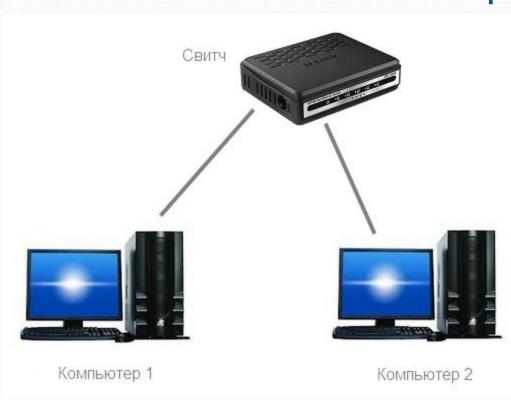
Компьютер 1 - Программное обеспечение моделирования работы датчиков (лазерного сканера, БИНС (возможно применение различных модификаций, в том числе и используемых в разработках ОАО «ВНИИ «Сигнал»), модуль геолокации GPS/ГЛОНАСС основанный на протоколе обмена IEC 61162-1 (NMEA-0183)) Компьютер 2 - Программное обеспечение отрисовки карты местности и реализация алгоритма объезда препятствий Свитч – осуществление связи между ПК по сети Ethernet
