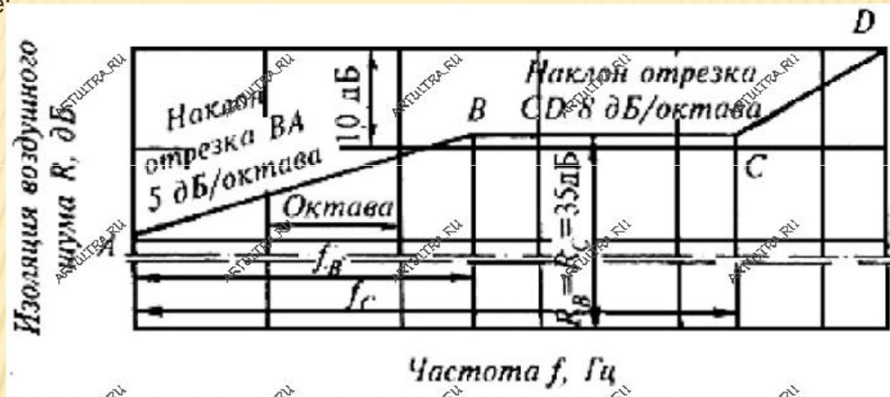
Для построения ломаной необходимы координаты точек В и С.  $R_B = R_C = 35$  дБ. При этом значения по оси абсцисс рассчитываются по формулам:  $f_B = \frac{6000}{h_1}$  и  $f_C = \frac{12000}{h_2}$ , где толщина стекла  $h_1 > h_2$ .
