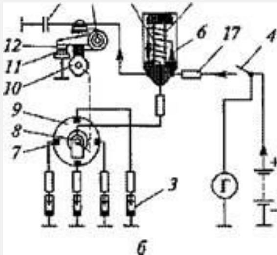
Контактная система зажигания:
