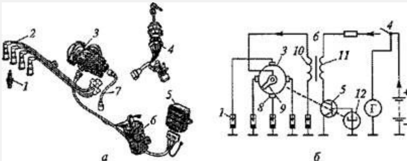
Бесконтактная система зажигания:
