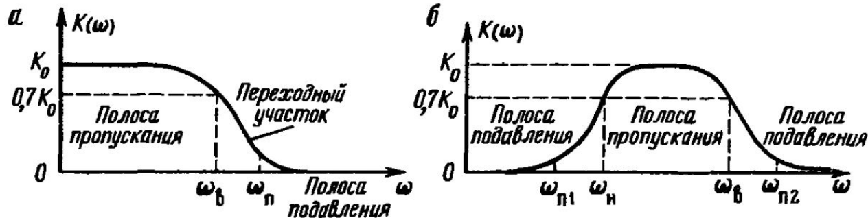
Рис. 58. Полосы пропускания и подавления фильтров нижних частот (а) и полосопропускающего (б)
