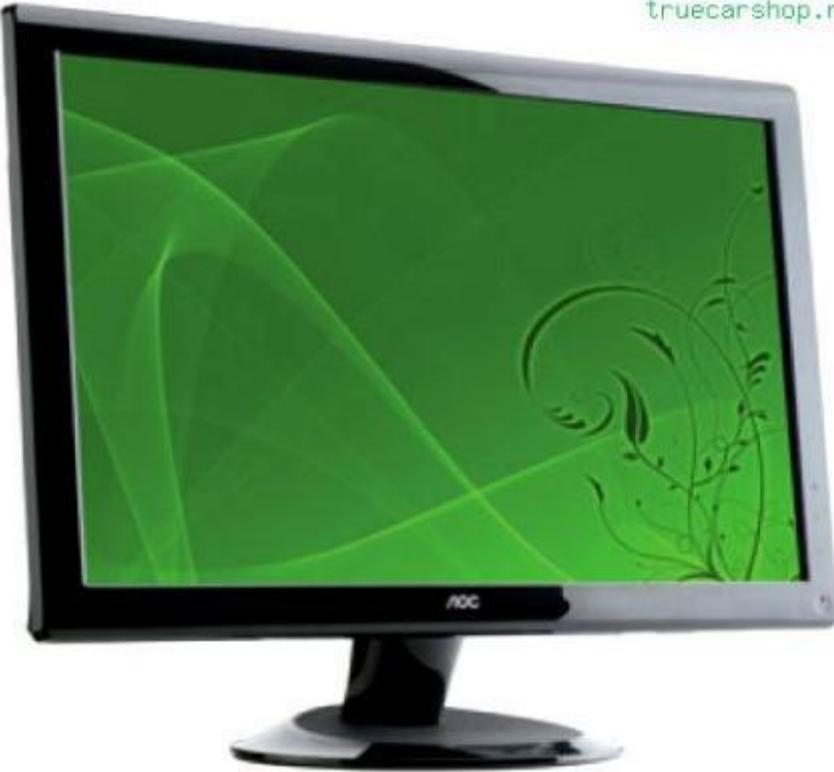
**ЖК мониторы** - это мониторы, созданные на основе жидкокристаллических панелей (по-английски LCD - Liquid Crystal Display).
