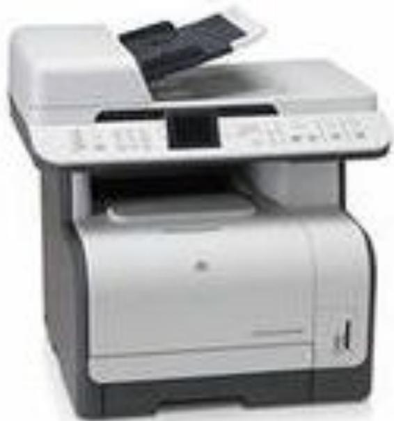
**Многофункциональное устройство (МФУ), — копируемый аппарат с дополнительными функциями принтера, сканера, факсимильного устройства.**
