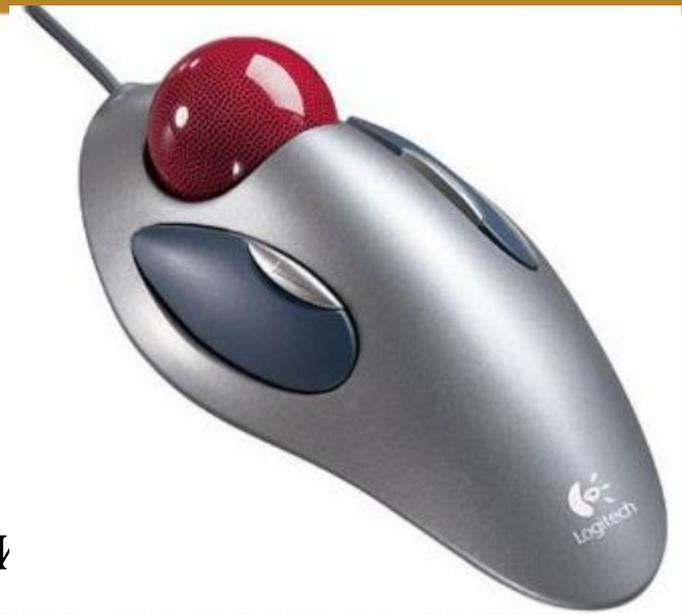
**Шар находится сверху и пользователь может вращать его ладонью или пальцами, при этом не перемещая корпус устройства. Несмотря на внешние различия, трекбол и мышь конструктивно похожи — при движении шар приводит во вращение пару валиков или, в более современном варианте, его сканируют оптические датчики перемещения (как в оптической мыши).**
