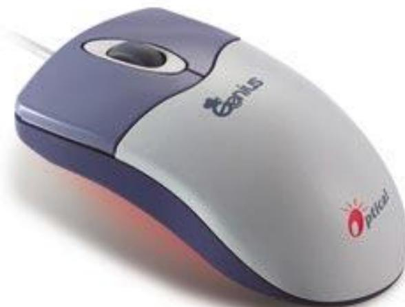
**В связи с широким распространением графических ОС и Интернета часто используют устройство управления курсором – «мышь», состоящую из двух кнопок (левой и правой) и колесом прокрутки, используемой для прокрутки текста, а в большинстве графических - для изменения масштаба изображений при использовании браузерами.**
