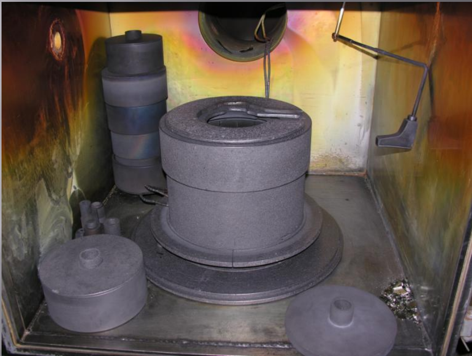
Ростовая камера с тепловым узлом из графита
