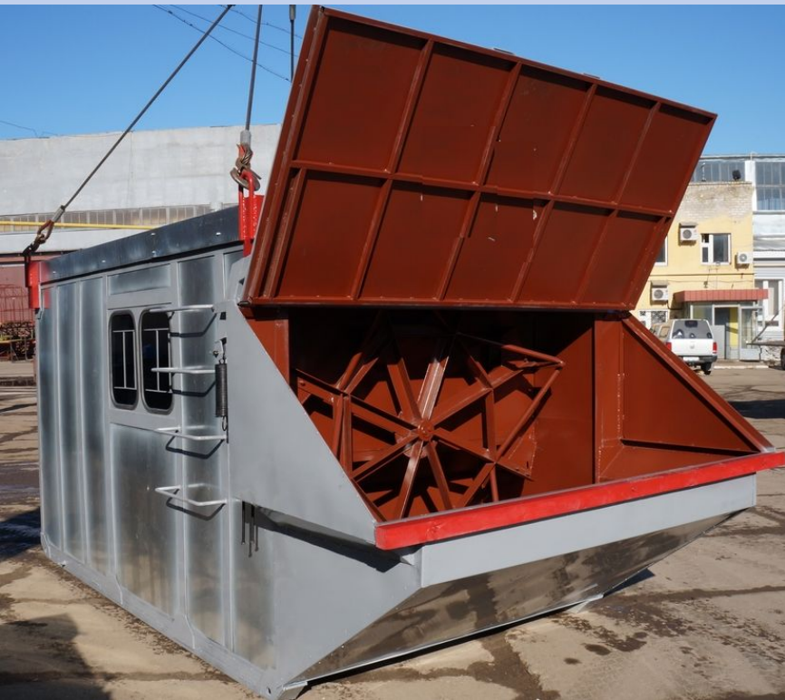
• Штукатурная станция ШС-4
