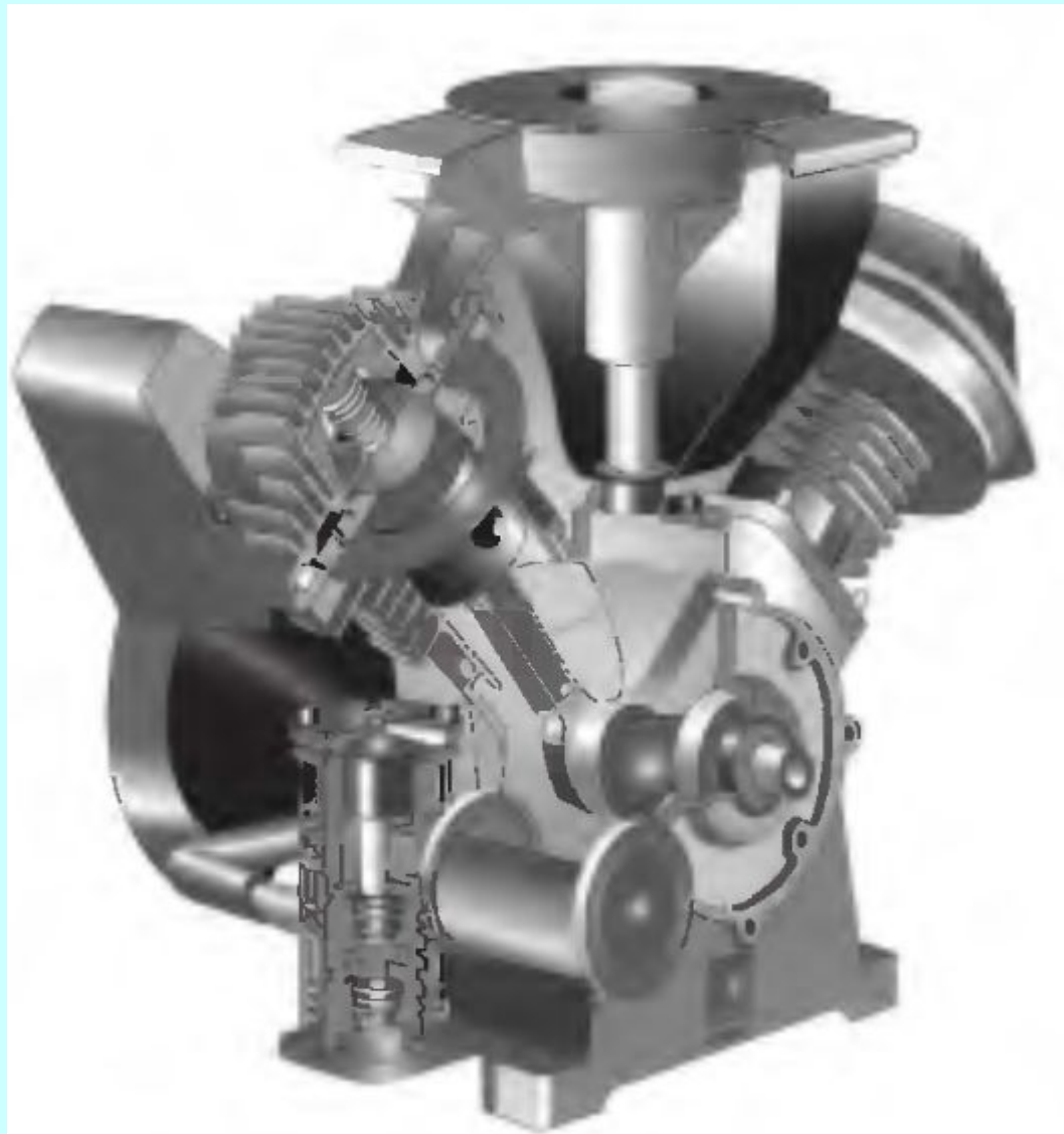
Рис. 4.1.1.а. Поршневой компрессор марки «Атлас Копко» V-образной конфигурации (вид в разрезе).
