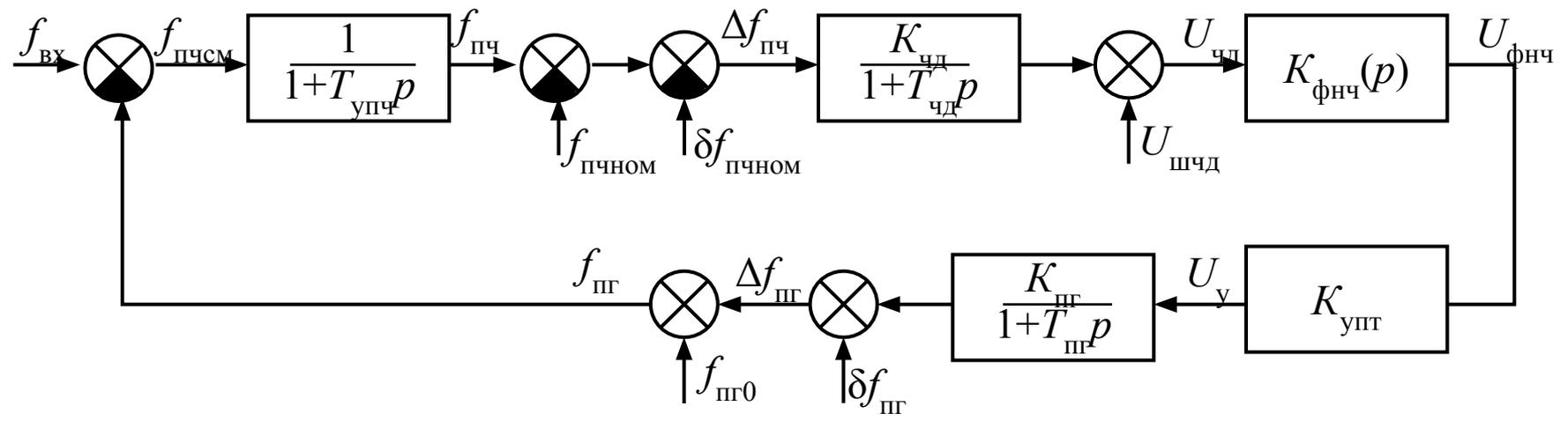
Преобразуем модель, объединяя арифметические операции с постоянными воздействиями  $f_{пчном}$  и  $f_{пг0}$  как в статической модели, а также заменяя последовательно соединенные линейные звенья одним звеном.
