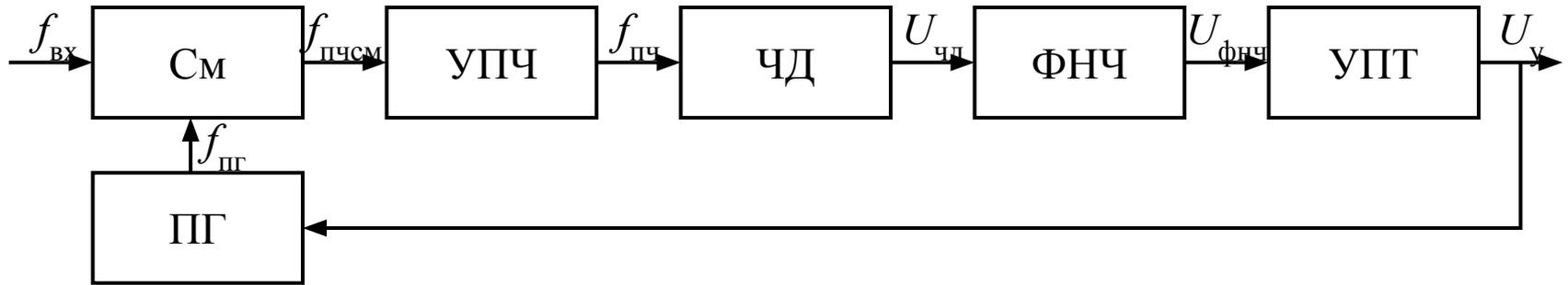
При составлении линейной модели нужно: 1) все нелинейные функциональные зависимости заменить линейными и 2) учесть динамические свойства элементов. Считаем, что выходной и входной процессы элементов связаны между собой так же, как выходное и входное напряжения интегрирующей цепи. Ее передаточная функция  $K(p) =$
