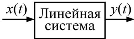
Линейная система устойчива, если при ограниченном входном воздействии  $x(t)$  выходной процесс  $y(t)$  тоже ограничен
