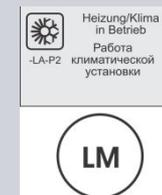
Эта сигнальная лампочка показывает, что система отопления, кондиционирования или вентиляции находится в рабочем режиме. Если лампочка не горит, то это означает, что установка не работает, например, из-за отсутствия электроснабжения. Возможно, следует включить режимы «Аварийная вентиляция» или «Аварийное отопление», питание которых осуществляется от батареи.
