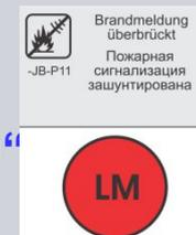
Эта сигнальная лампочка указывает на замыкание установки пожарной сигнализации.
