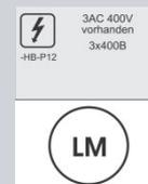
Эта сигнальная лампочка показывает, что имеется 3 x 400 В и 3 x 400 В/230 В - бортовой сети. Бортовые сети питаются от преобразователя постоянного тока в переменный EVB (железнодорожной) или от местной электросети и необходимы для работы устройств дополнительного отопления, воздушного отопления и других потребителей трехфазного и однофазного тока.
