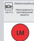
Эта сигнальная лампочка показывает, устройство противоюзовой защиты подает сигнал об ошибке. Возможно, не работает электромагнитный тормоз, и/или открытие двери заблокировано при скорости ниже 5 км/ч. Детали можно посмотреть на диагностическом дисплее в служебном купе.
