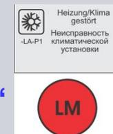
Эта сигнальная лампочка указывает на ошибку в системе отопления / кондиционирования / вентиляции. Возможно, функционирование отопления, кондиционирование или вентиляции ограничено или невозможно. Детали можно посмотреть на диагностическом дисплее в служебном купе.
