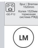
Эта сигнальная лампочка показывает, что была определена ширина колеи 1520 мм, и что пневматический тормоз и устройство противоюзовой защиты работают в режиме „РЖД“. Система электропневматического тормоза и система блокирования экстренного торможения (системы DB и UIC) отключены. Мигание лампочки свидетельствует о неясном состоянии.
