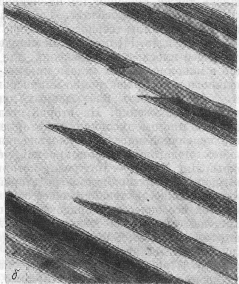
Рис. 6.20. Сплав серебра с 10 ат.% галлия, деформированный на 5% при комнатной температуре (а), и сплав серебра с 17 ат.% галлия, деформированный на 5% при комнатной температуре (б) (электронные микрофотографии, X 50 000)
