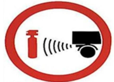
**ЗАПРЕЩАЮТСЯ** все работы при работающем двигателе, кроме регулировки двигателя и опробования тормозов
