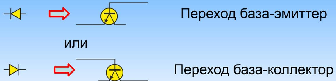
Два диода можно заменить одним транзистором
