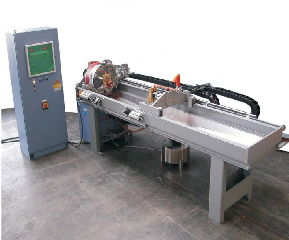
дефектоскоп «Universal-SW» фирмы
