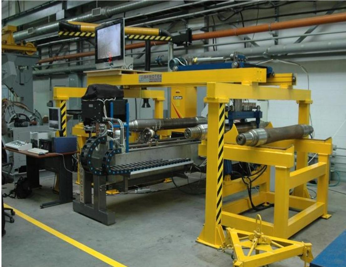
Предназначен для МП контроля свободных осей колесных пар железнодорожного подвижного состава, автоматического выявления дефектов, протоколирования и архивирования результатов контроля, маркировки дефектных участков
