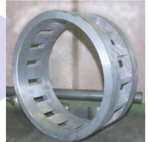
Износостойкий чугун (роторный измельчитель)
