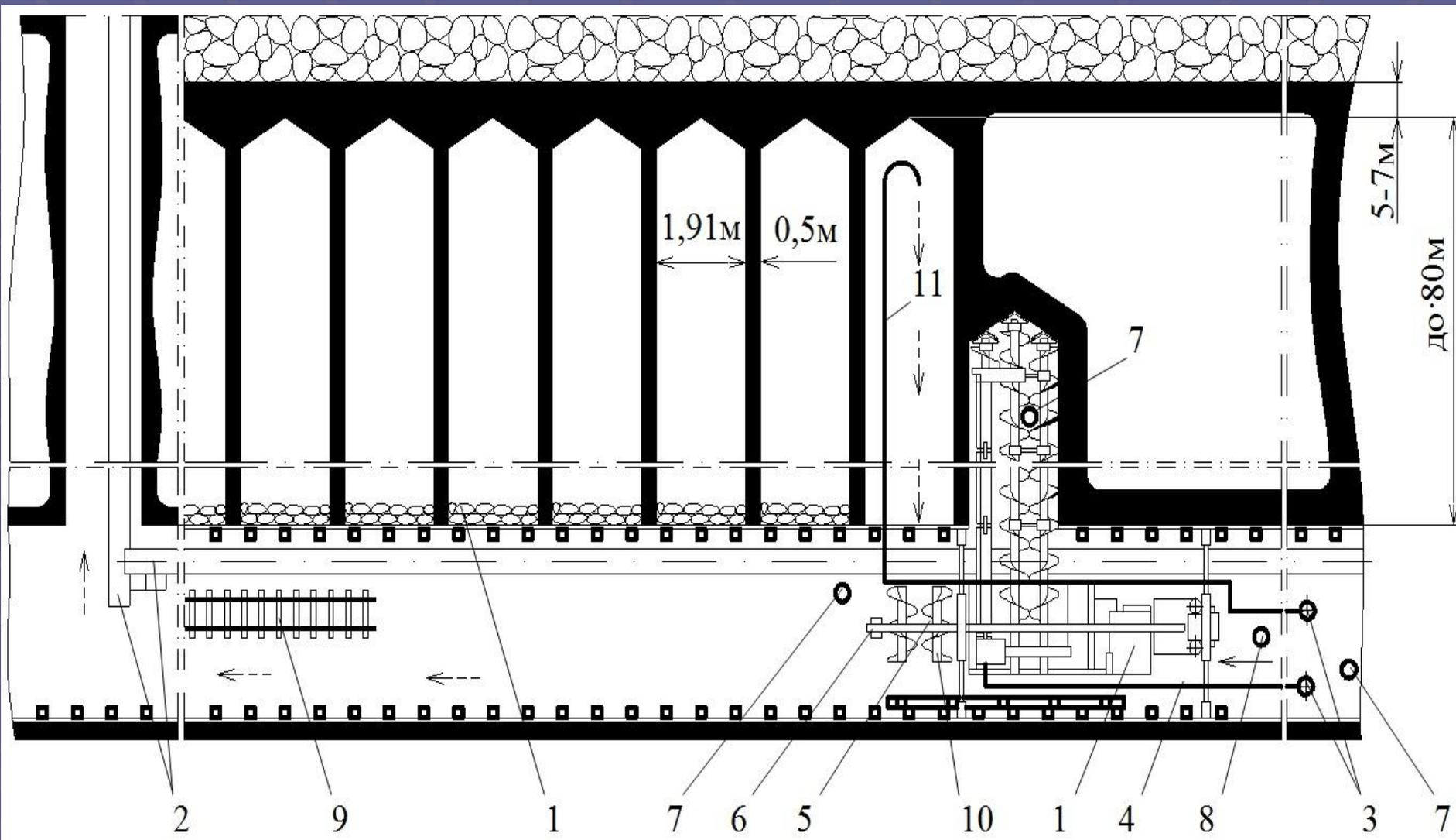
Технологическая схема выемки угля одной бурошнековой машиной или комплексом:
