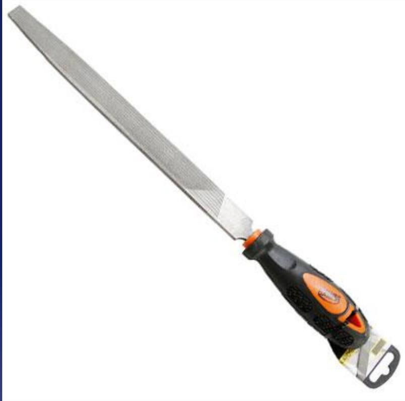
**Напильник** представляет собой стальной закаленный брусок с насеченными на рабочих поверхностях правильно расположенными мелкими зубьями. Насечка напильника может быть одинарной под углом  $70^{\circ}$ — $80^{\circ}$  к ребру напильника и двойной (перекрестной). При двойной насечке нижнюю делают под углом  $55^{\circ}$ , а верхнюю— под углом  $70^{\circ}$ . Угол заострения зуба напильников—  $70^{\circ}$ .
