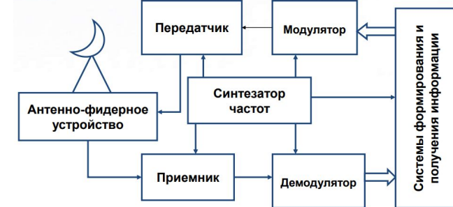
Обобщенная схема радиотехнической приемно-передающей системы
