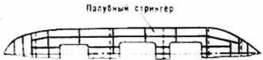
Растяжка наружной обшивки и верхней палубы
