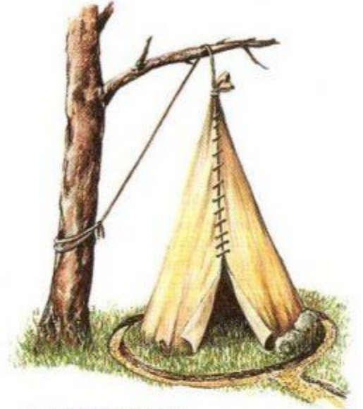
Водосток вокруг укрытия.
