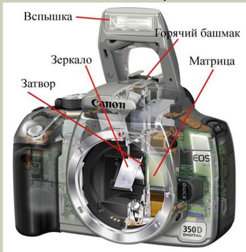
Матрица состоит из множества светочувствительных ячеек – пикселей. Ячейка при попадании на нее света вырабатывает электрический сигнал, пропорциональный интенсивности светового потока.
