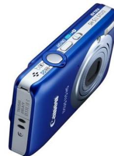
Электрический привод зум-объектива. Невозможность оперативно изменять фокусное расстояние с помощью механического кольца и необходимость пользоваться вместо этого маленькими кнопками очень раздражает. К тому же моторчик объектива часто движется рывками, исключая точное кадрирование.
