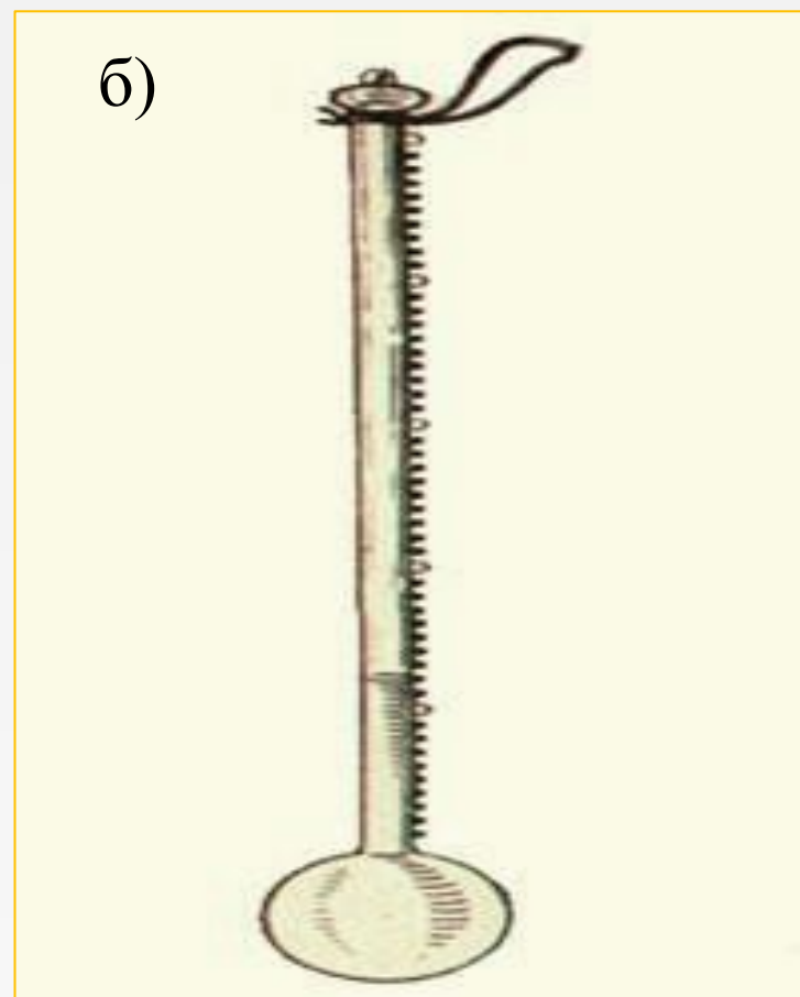
Рис.2. Термоскоп: а) Г. Галилея б) Ф. Мидичи
