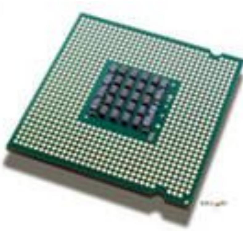
**Мозг системного блока, выполняет логические операции. От его скорости, частоты во многом зависит быстродействие компьютера и вся его архитектура.**
