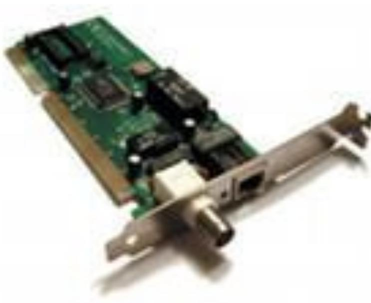
**Сетевая карта служит для соединения компьютера с другими компьютерами по локальной сети или для подключения к сети Интернет.**
