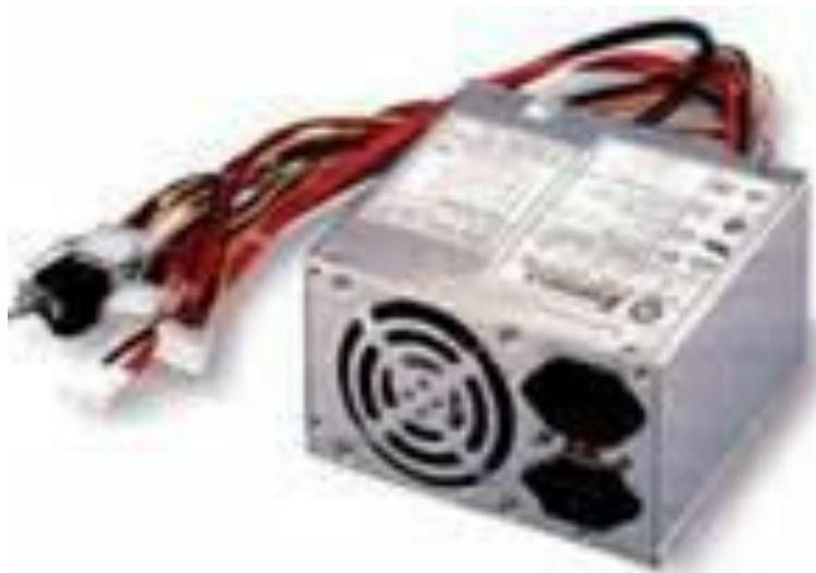
**Блок, который питает все устройства внутри компьютера. Блоки питания отличаются по мощности. Чем мощнее блок питания, тем больше устройств вы сможете подключить в нутрии системного блока.**
