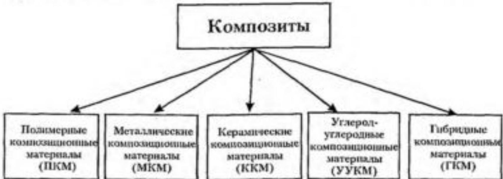
Рис. 1.2. Классификация композиционных материалов
