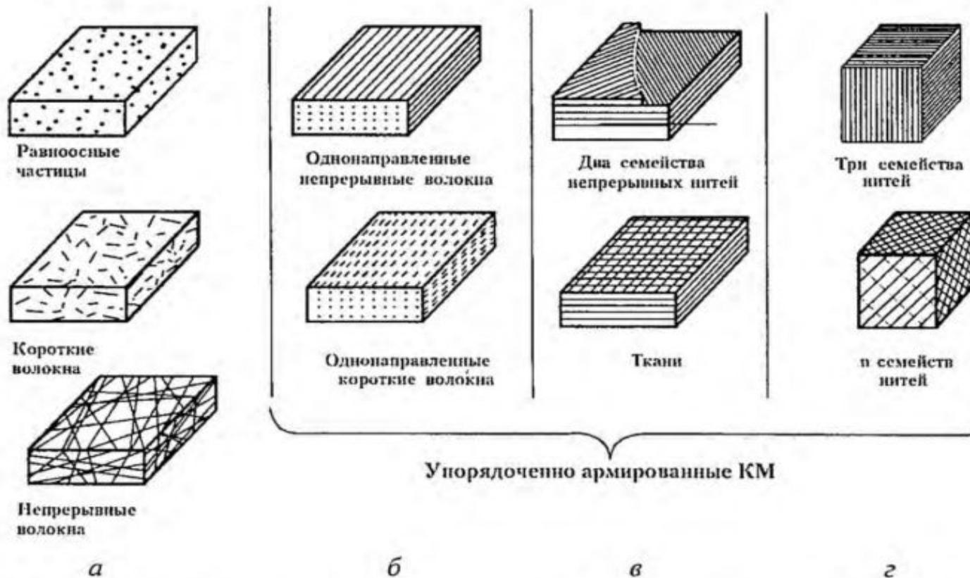
Рис. 1.7. Классификация композиционных материалов по конструкционному признаку: хаотично-, одномерно- и пространственно армированные КМ (*a* – *г* соответственно)
