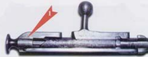
фото 5. Неполная разборка. Извлеченный затвор. В таком положении курок 1 взведен.
