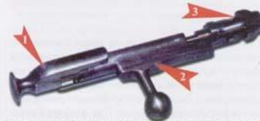
фото 6. Разборка затвора. Удерживая курок 1 повернуть по часовой стрелке ствол затвора 2. В таком положении курок спущен. Подать вперед боевую личинку 3.
