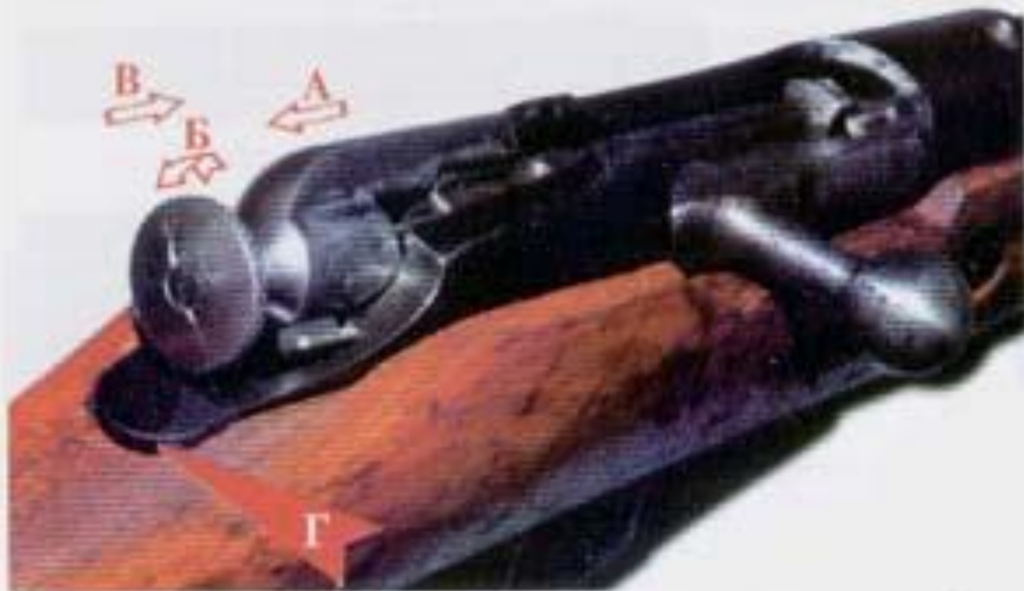
Фото 22. Винтовка, поставленная на предохранитель. Смотри последовательность действий в тексте. Г - зазор.
