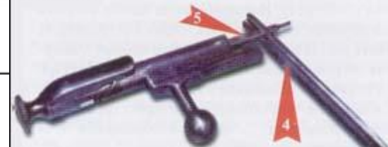
фото 7. Разборка затвора. Боевую личинку 3 повернуть отняв часовой стрелки и отделить вперед от соединительной планки 4.
