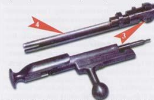
фото 7. Разборка затвора. Боевую личинку 3 повернуть отняв часовой стрелки и отделить вперед от соединительной планки 4.
