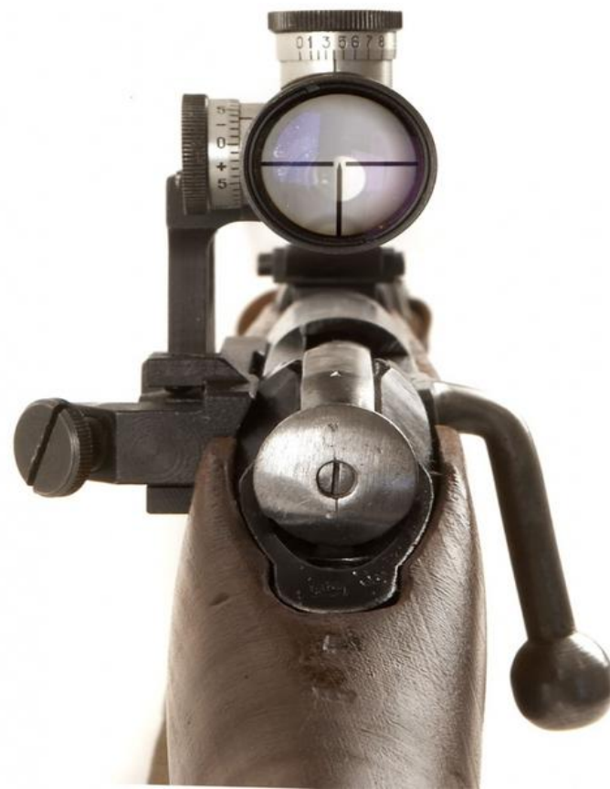
фото 24. Снайперская винтовка. Стрелкой А показано место "подклейки" фетровой прокладки между стеблем затвора и ложей. Б - взаимное расположение винтовой части, ударника и курка при правильно собранном затворе.
