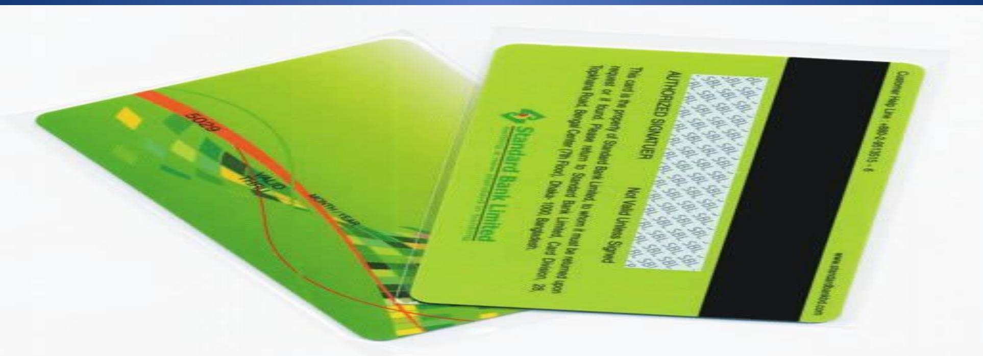
Карта с чипом ( *smart card* ) — пластиковая карта со встроенной микросхемой .В большинстве случаев смарт-карты содержат микропроцессор и операционную систему, контролирующую устройство и доступ к объектам в его памяти. Кроме того, смарт-карты, как правило, обладают возможностью проводить криптографические вычисления.
